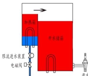
3. 因为有限流进水装置和底部布水器的作用，进入箱内的水不会冲散开水层，所以只把开水顶到开水储箱中。
